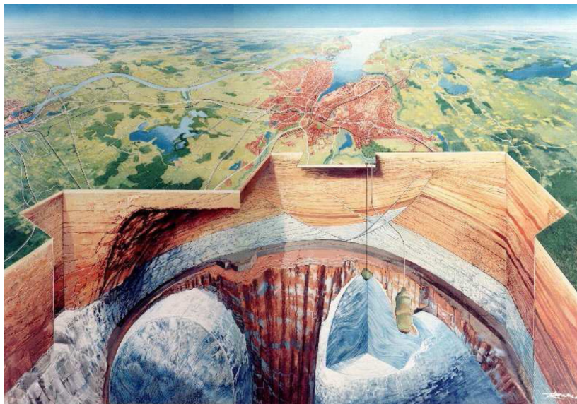
Abb. 2.25: Schematischer Schnitt durch einen Salzstock
